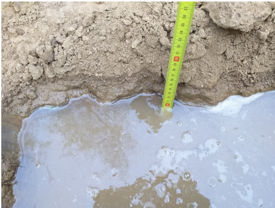
Figura 51 – Particolare di esecuzione della prova di permeabilità in foro.
